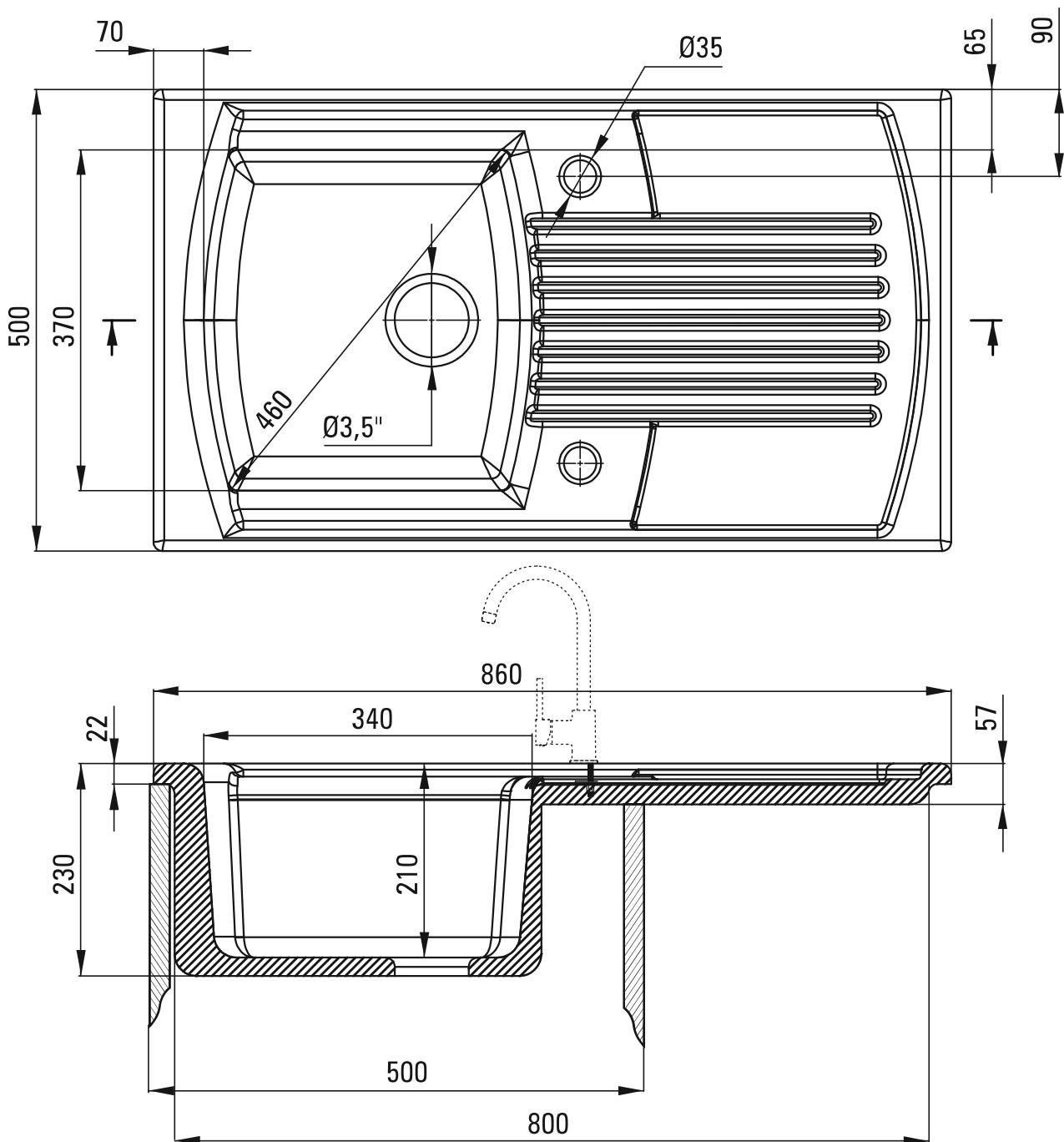
Rozměrová tolerance  $\pm 5\%$  pro hodnoty do 200 mm a  $\pm 3\%$  pro hodnoty nad 200 mm
