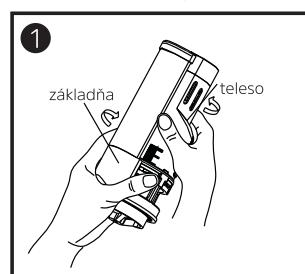
Otočením telesa splachovacieho ventilu oddeľte teleso od základne, rovnako ako je znázornené na obrázku.
