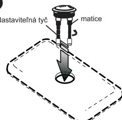
Zarežte nastaviteľnú tyč na správnu dĺžku a vložte tlačidlo do otvoru.
