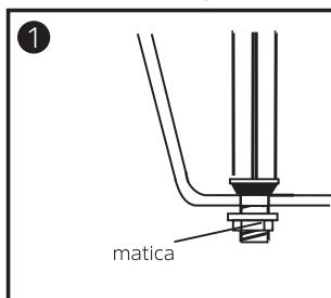
Odskrutkujte maticu a vložte napúšťaci ventil do otvoru v nádrži. Uistite sa, že je ventil v polohе, ako je znázornené, a utiahnite maticu.
