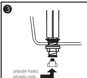
Odšroubujte matici a vložte napouštěcí ventil do otvoru v nádrži. Ujistěte se, že je ventil v poloze, jak je znázorněno, a utáhněte matici.
