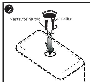
Zařízněte nastavitelnou tyč na správnou délku a vložte tlačítko do otvoru.
