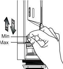
Pri pohybe červeného nastavovacieho kusu zdola nahor sa objem plného spláchnutia postupne znižuje. Nastaviteľná vzdialenosť je 20 mm (13-16").
