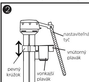
Otočte nastaviteľnú tyč o 90° a vytiahnite ju. Posuňte pevný krúžok pre nastavenie vnútorného plaváku, nastaviteľnú tyč dajte do najnižszej polohy. Vložte tyč do vnútorného plaváku, potom tyč otočte a zaistite.
