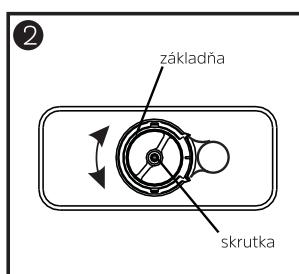
Nainštalujte základnú splachovacieho ventilu do výpustie tak, aby sa spona „U“ správne zacvakla do nádrže. Otočením základne zvolte správny uhol a zaistite skrutku.
