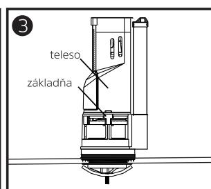
Znovu nainštalujte telo splachovacieho ventilu na základnu, otočte ho do správnej polohy a zaistite.
