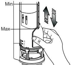
Pri pohybe plaváka pre čiastočné spláchnutie zdola nahor sa objem čiastočného spláchnutia postupne znižuje. Nastaviteľná vzdialenosť je 60 mm (2-1/4").
