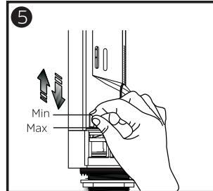
Při pohybu plováku pro částečné spláchnutí zdola nahoru, se objem částečného spláchnutí postupně snižuje. Nastavitelná vzdálenost je 60 mm (2-1/4").
