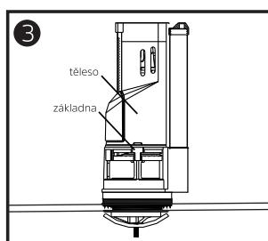
Otočením tělesa splachovacího ventilu oddělte těleso od základny, stejně jako je znázorněno na obrázku.
