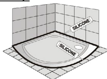
Zapuštěná do podlahy
