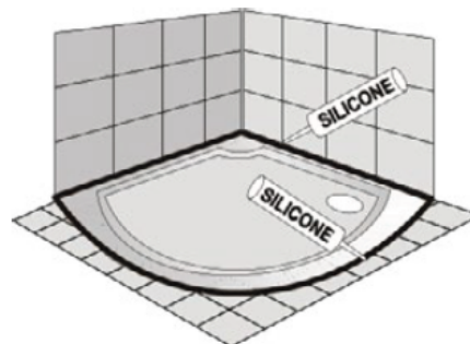
Zapustená do podlahy
